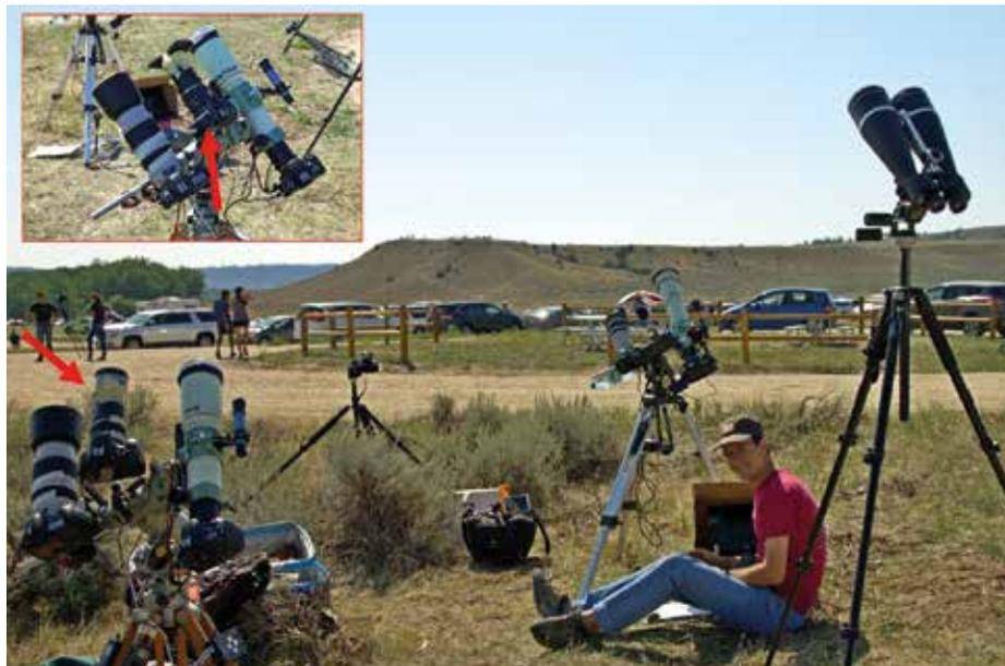
↑ Le frecce indicano il teleobiettivo 100-400 mm, settato a 270 mm e dotato di reticolo di diffrazione sopra l'obiettivo, con cui Comolli e Sordini hanno realizzato gli spettri flash della cromosfera/corona, utilizzando una Canon 450D senza filtro IR.
