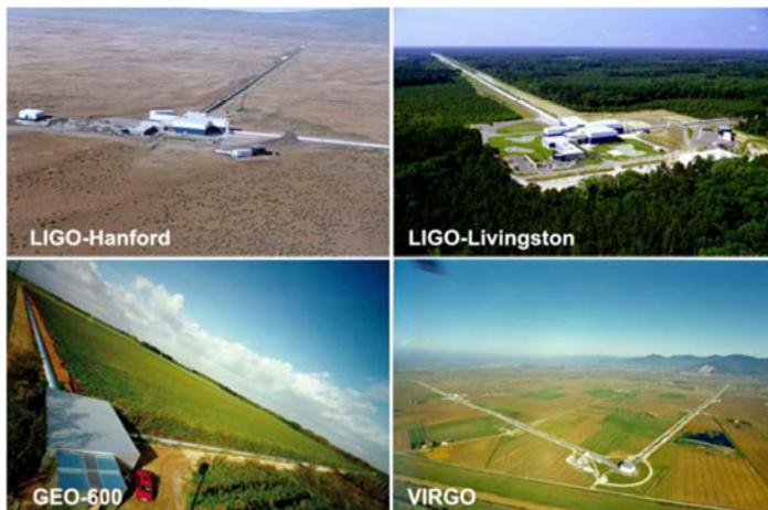
LIGO venne fondato nel 1990 per opera di Kip Thorne e Ronald Drever del Caltech e Rainer Weiss del MIT. La costruzione venne completata nel 1999 e dal 2002 lo strumento divenne operativo. Due raggi laser si propagano lungo due bracci tra loro perpendicolari lunghi 4 km, larghi 1,2 metri e all'interno dei quali si trova il vuoto più spinto ( $10^{-12}$  Atm) che possiamo sperare di
