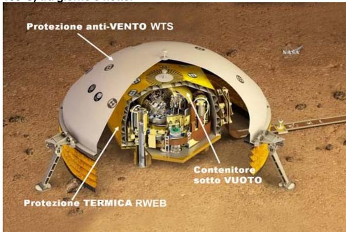
Ad ulteriore protezione c'è il cosiddetto WTS (Wind and Thermal Shield), un cappuccio esterno di Alluminio di 69 cm di diametro, 35 cm di altezza e 9,5 kg di peso il cui compito, come dice il nome, è di proteggere ulteriormente il sistema dai forti venti locali vento ( grazie ad una forma aerodinamica che, sotto vento, fa schiacciare il TWINS verso il suolo):
